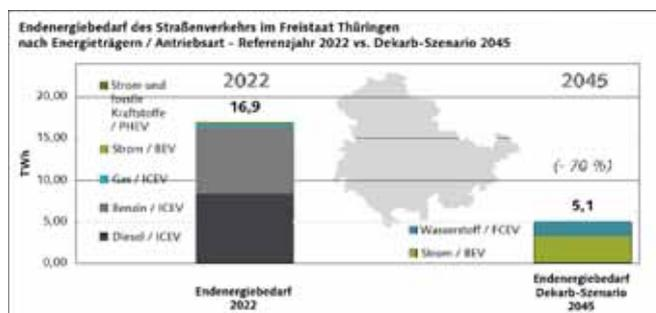
Abbildung 3: Ergebnis der Endenergiebedarfsermittlung für den Thüringer Straßenverkehr
