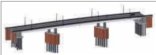
Bild 12: Isometrie mit Gründungsdarstellung © SSF Ingenieure AG
