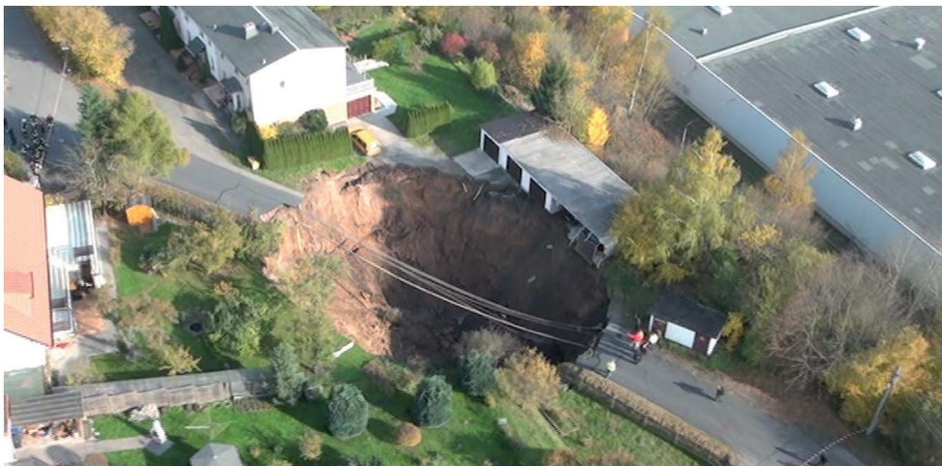
Abb. 4: Schmalkalden am 1. November 2010, ein Erdfall mit 25 m Durchmesser und 17 m Tiefe inmitten eines Wohngebietes sorgte international für Aufsehen. Ursache für das Auftreten dieses Erdfalls waren Auslaugungsprozesse in 80 bis 130 m Tiefe in Anhydriten der Werra-Folge während des Zechsteins (Schmidt, Wunderlich & Peters 2013).
